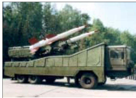
Колесное шасси заставило специалистов «Оборонительных систем» ограничиться двумя направляющими.
