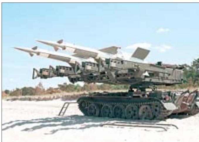
Вопреки существующей ныне «моде на колеса», поляки установили пусковую установку на гусеничном шасси
